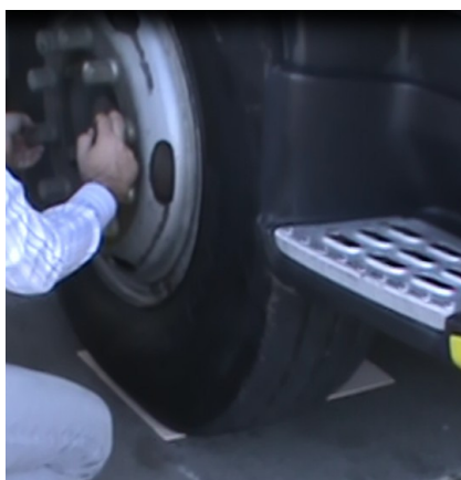
Figura 3. Posicionamento da placa de EVA para impressão
